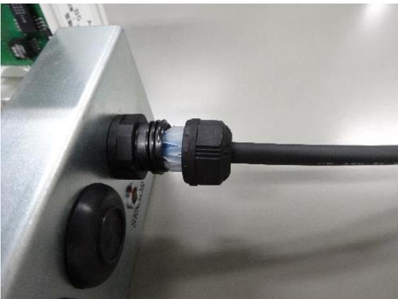
⑥ 扉側の基板にコネクタを差し込み、ケーブルの長さを調整します。
