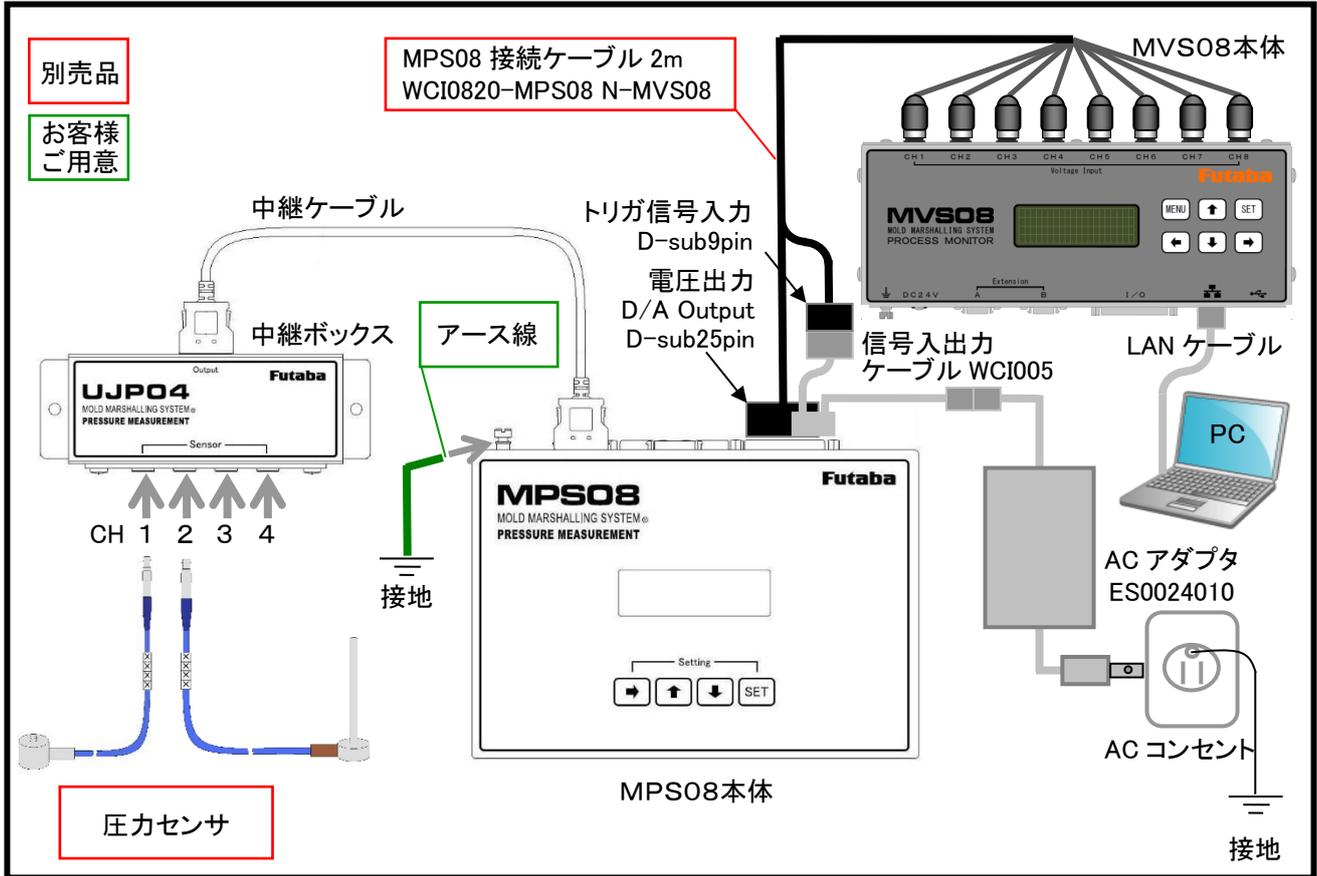
[注] 図中の MPS08 はスタンドアロン(単独動作)を想定しています。PC 接続動作には別途 PC が必要です。MPS08 本体内部に計測条件設定ファイルを保存できますが、計測条件の変更には PC 接続が必要です。
