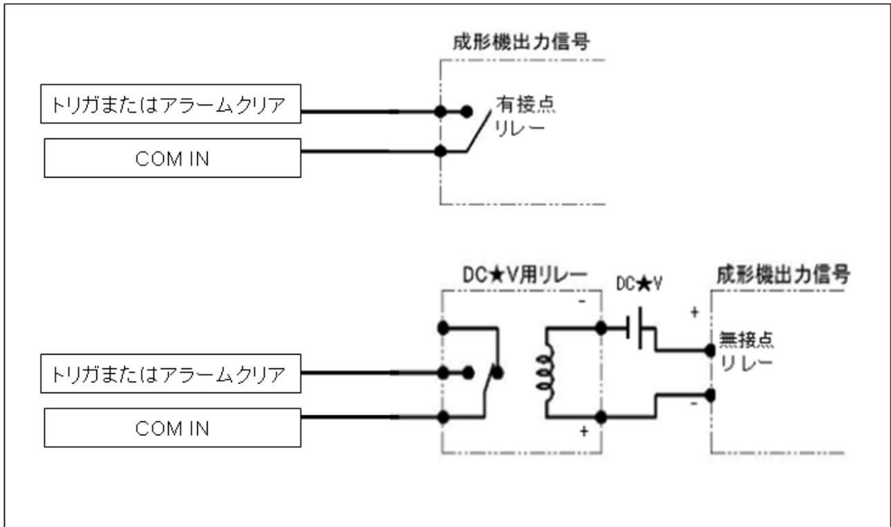
例 2: 接続先の成形機出力が「電圧出力」の場合
