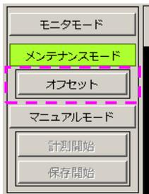
\* センサの出力が強制的にリセットされます(樹脂温度センサは金型温度になります)。
