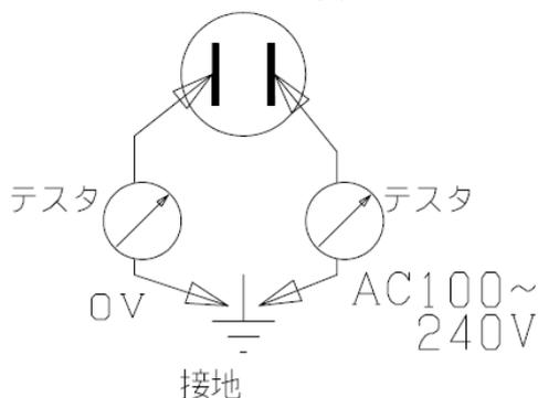
③ 誘導電動機、電気溶接機などのノイズが発生する機器を使用している現場では、ノイズが多く電源状態が悪いと予測されます。市販の絶縁トランスやノイズカットトランスを使用してノイズ対策を実施してください。
