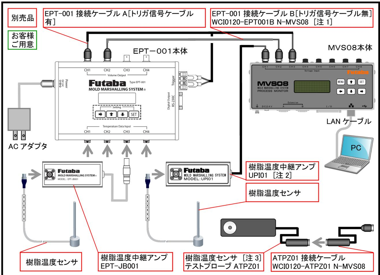
[注 1] EPT-001 接続ケーブル A は、EPT-001 の CH1 の接続に使用します。トリガ信号を取込みできます。
