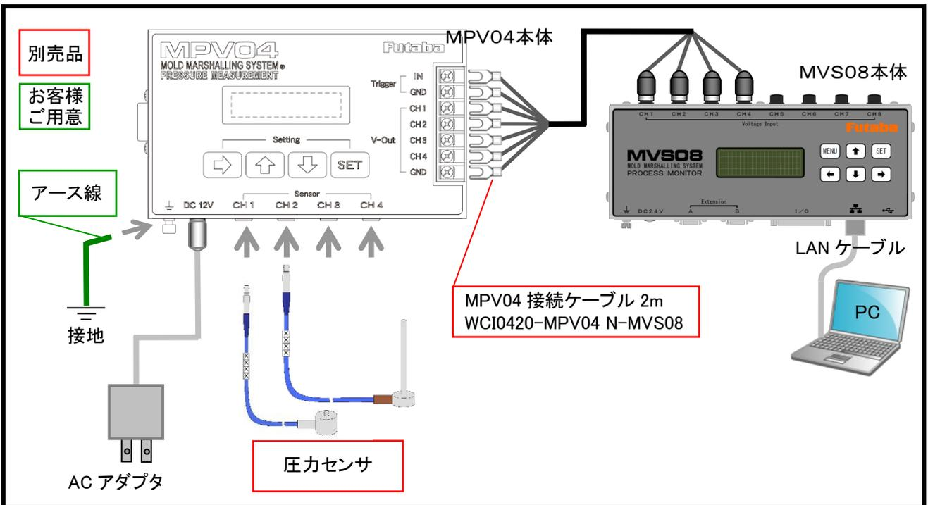
(4) インライン樹脂圧力計測ユニット「MPS01A」接続時…「MVS08」側は(1)P.13 をご参照ください。
