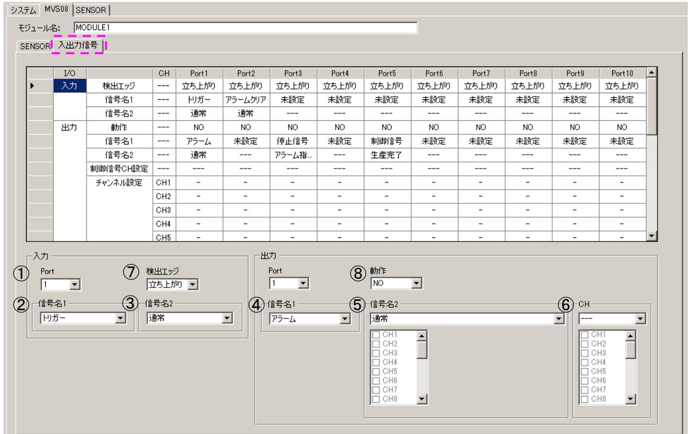
①の「Port」を選択し、入力信号および出力信号を設定してください。⑥「CH」により、どのチャンネルのアラームかを特定することもできます。複数「CH」にチェックすれば共通のアラームになります。なお、必ず「トリガ」を入力した状態で計測を行ってください。
