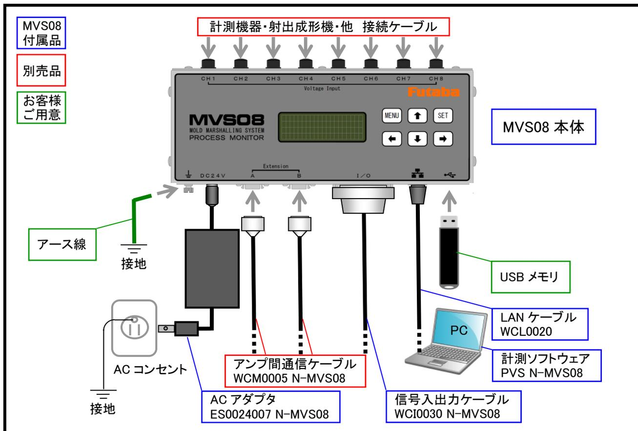
「MVS08」は上図のように、計測機器を専用のケーブルで接続する構造になっています。
