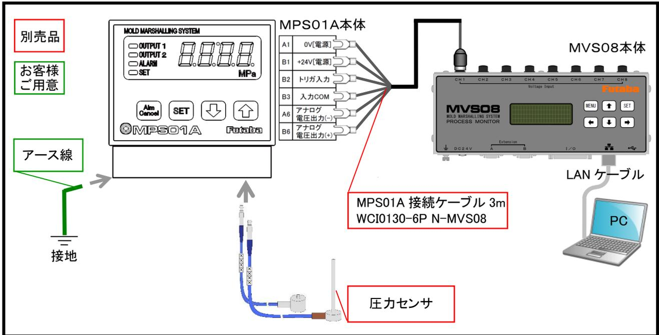
[注] MPS01A 接続ケーブルにより MVS08 から電源供給されるので、電源ケーブルやACアダプタが不要です。
