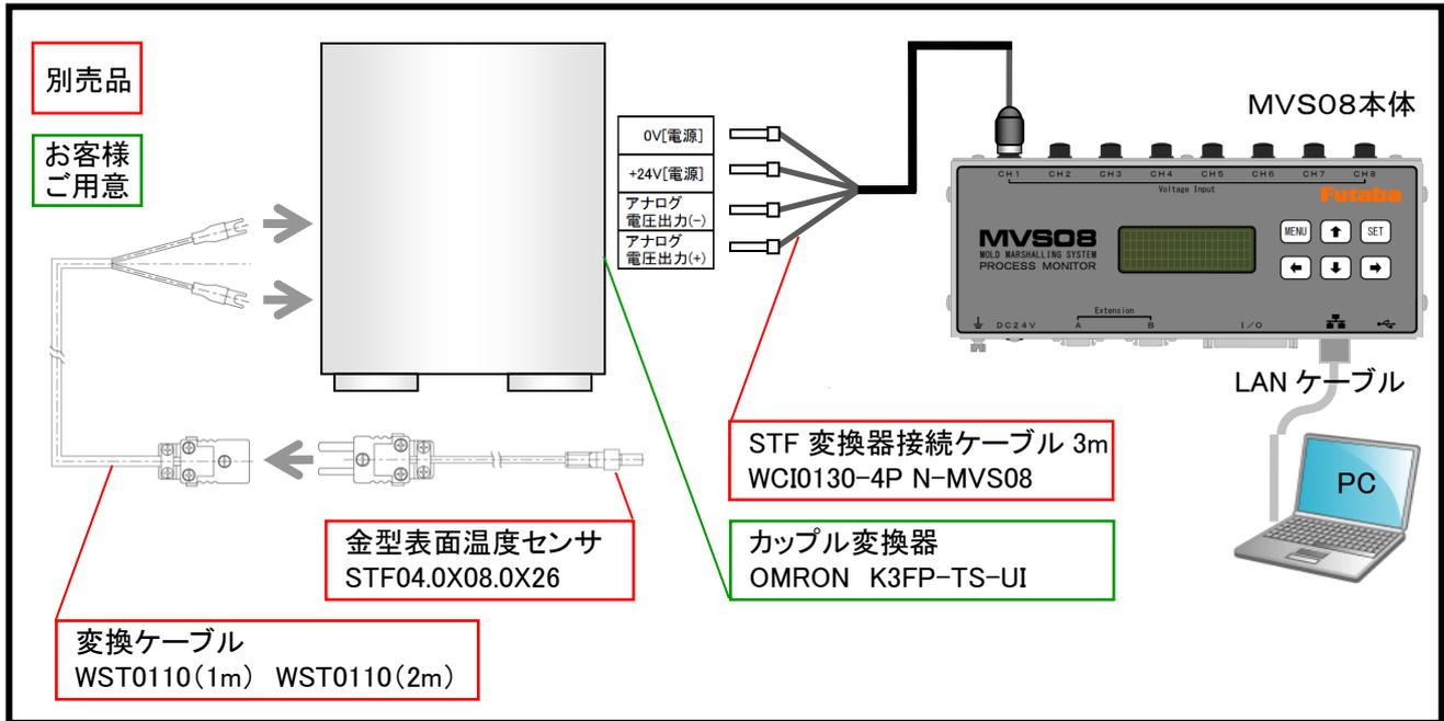
(7) その他の計測機器、射出成形機、接続時…「MVS08」側は(1)P.13 を参照してください。
