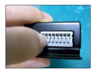
・写真のようにスイッチを押すことで結線用のバネが開閉し、 端子台へケーブルを固定することが出来ます。
